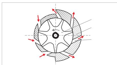
Nejrozšířenější typ průmyslového vodoměru. Voda na lopatkové kolo natéká ze všech stran, ložisko není zatěžováno axiálně. Obvyklý vodoměr pro dimenze DN25 až DN50. Je povolena montáž pouze do vodorovného potrubí. Pro montáž do svislého potrubí se vyrábějí speciální varianty – do „stoupačky“ a „klesačky“ (podle směru proudění – číselník vždy směrem nahoru). Mohou být jak suchoběžné, tak i mokroběžné, nejčastěji se závitovým připojením.
