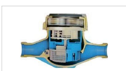
Může být jednovtokový i vícevtokový. Počítadlo je ponořeno v kapalině a je pod tlakem. Nevýhodou je možnost zanesení počítadla nečistotami a vodním kamenem z kapaliny. Výhodou je absolutní antimagnetičnost.
