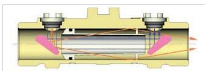
V průtokoměrné jednotce je UZ signál vysílán ve formě impulsu ve směru a proti směru proudění měřené kapaliny. Princip měření využívá časového rozdílu při průchodu impulsů v obou směrech šíření. Výsledný údaj nezávisí na rychlosti UZ signálu v médiu (nezávisí na složení média, na teplotě a na tlaku). Výhodné jsou nezávislosti na síťovém napájení, malou tlakovou ztrátou, měřením malých i velkých průtoků a vícekanálové provedení umožňuje velmi přesné měření.
