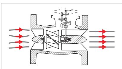
Obvyklý typ vodoměru od dimenze DN50 výše. Osa lopatkového kola (turbínky) je v ose proudění a navazuje na ni úhlový převod. Pro svislou, vodorovnou i šíkmou montáž. Obvykle přírubové připojení. Pouze suchoběžné provedení.
