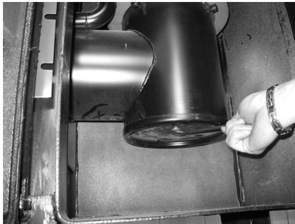
demontáž spodního víka retorty
