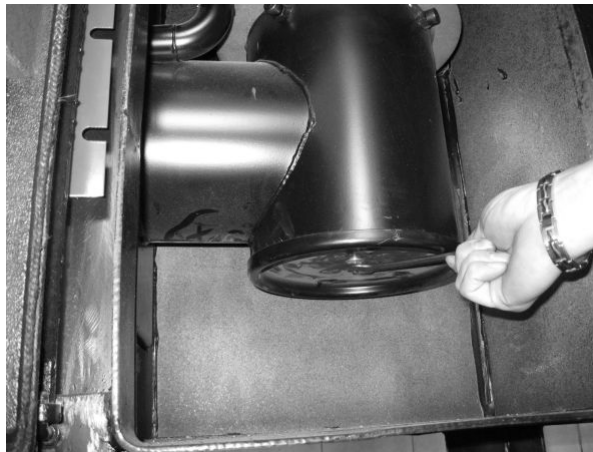
demontáž spodního víka retorty
