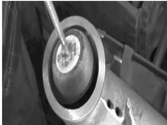
leštění kolena pomocí brusného kotouče
